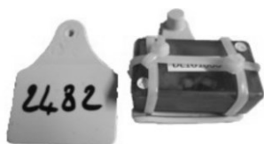
Photo 1 – Fixation de l'accéléromètre
